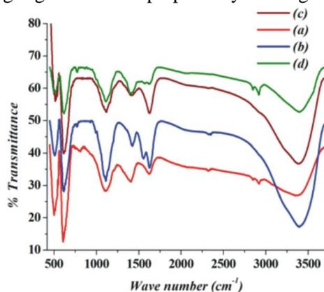
Figure 5. FT-IR spectra of  $Mn_2O_3$  with CTAB variation (a) 0 mg, (b) 20 mg, (c) 50 mg and (d) 100 mg.
