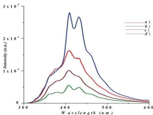
Figure 6. PL spectra of  $Mn_2O_3$  with CTAB variation (a) 0 mg, (b) 20 mg, (c) 50 mg and (d) 100 mg.
